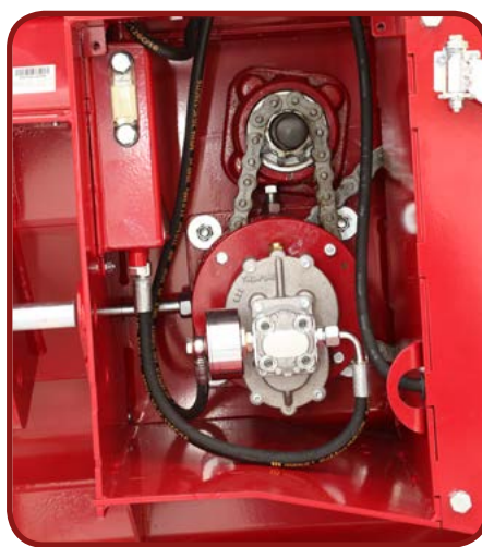
Antrieb der Hydraulikpumpe über Getriebe mit Druckfilter
